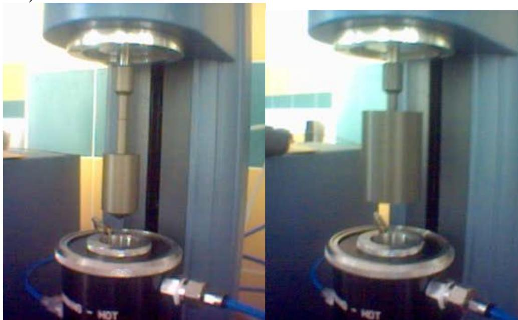
Photo gauche : géométrie couette (cylindres co-axiaux) ; photo droite : géométrie double couette (cylindres co-axiaux à double entrefer)
