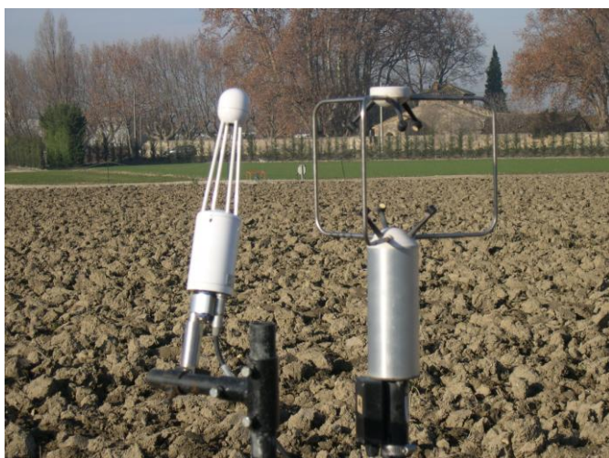
Instrumentation pour la mesure des flux de CO 2 et de H 2 O (financement région et IFR)
