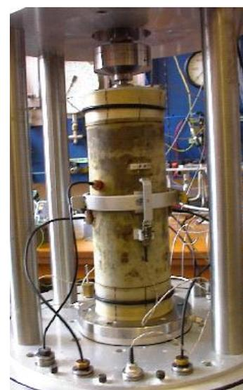
Fig.2- Echantillon triaxial finement instrumenté
